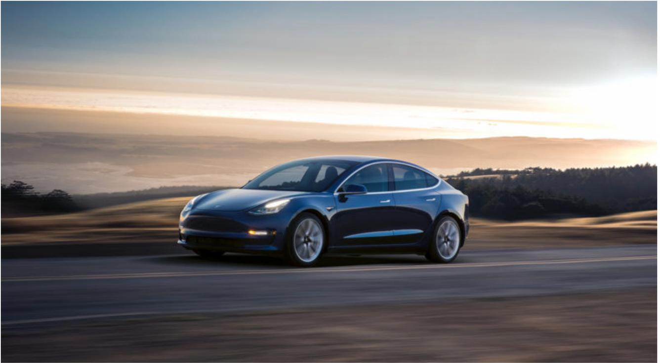
L'aerodinamica è stata maniacalmente curata per aumentare l'autonomia. Per esempio, le maniglie delle porte a filo carrozzeria limitano i vortici dell'aria durante la marcia. L'obiettivo progettuale del coefficiente di resistenza aerodinamica era 0,21, il risultato 0,23. **Gli interni?** Minimalisti, in stile Musk. Tutte le possibili funzioni dell'auto si controllano da un grande schermo flottante da 15 pollici posto al centro della plancia.
