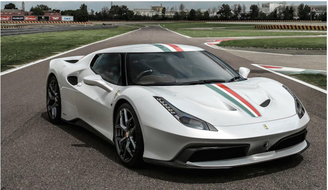
In questo caso **la base prediletta di un ricco inglese è la 458 Speciale**, una supercar con oltre 600 CV ed un'aerodinamica attiva: l'elettronica interviene su piccole pendici per migliorare l'assetto della macchina in movimento. **La MM Speciale vanta in più** una carrozzeria interamente in alluminio, a vantaggio di peso e rigidità alle alte velocità, oltre ai paraurti in fibra di carbonio.
