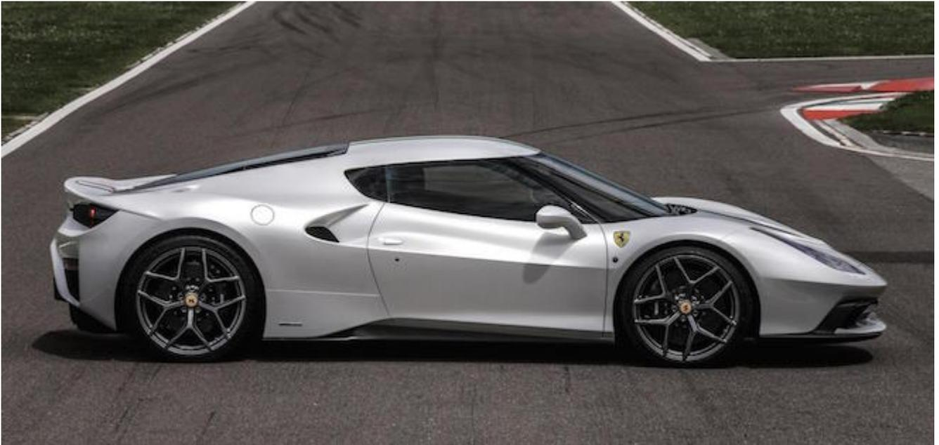
Parabrezza e finestrini laterali sono uniti in un unico gesto, con il montante anteriore verniciato di nero per assicurare una perfetta transizione grafica **come sulla GT0 del 1984**. Dietro la coda termina in maniera diversa dall'auto di derivazione, e con una **nuova presa d'aria laterale**, si completa la profonda revisione del pacchetto aerodinamico.
