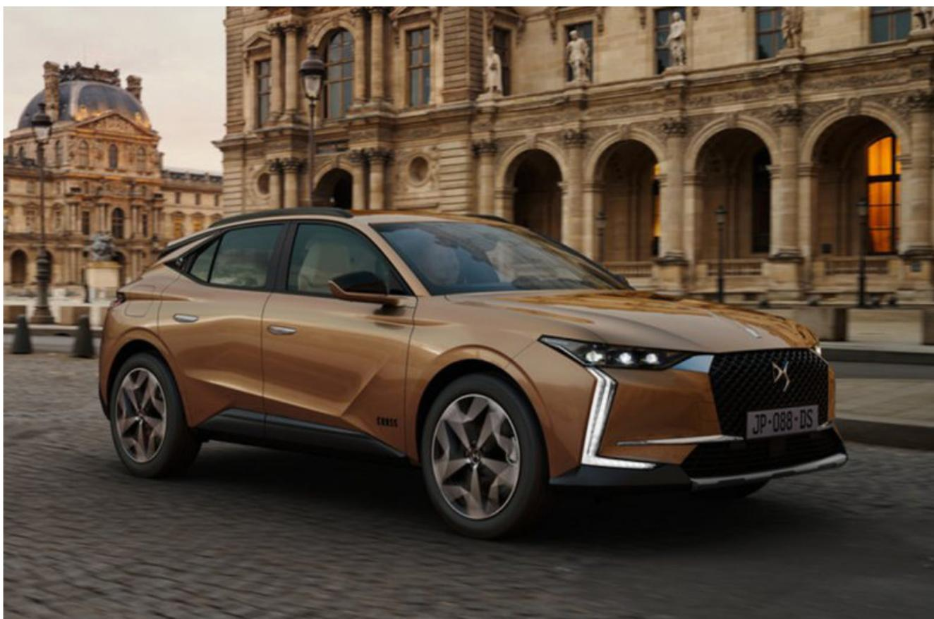
La nuova DS 4 E-TENSE associa un motore a benzina da 180 CV ad un motore elettrico da 110 CV.
