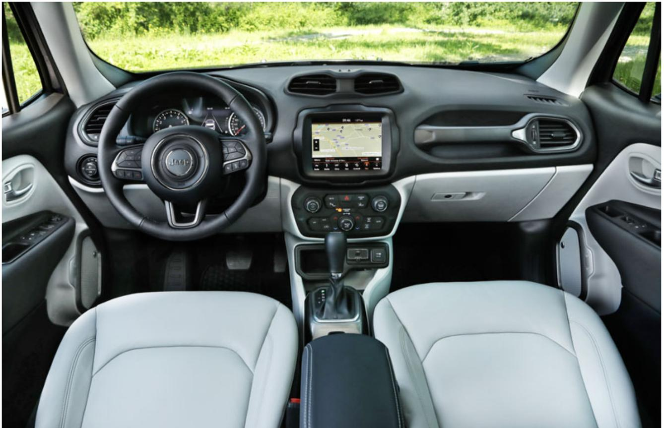
Chiudiamo con l'elettronica. L'apparato multimediale della Jeep Renegade 2019 offre l'ultima versione del sistema Uconnect su schermi da 5 ad 8,4 pollici e compatibilità smartphone Apple Carplay-Android Auto. L'assistenza alla guida prevede ora di serie su tutte le versioni l'avviso invasione corsia e il regolatore di velocità intelligente basato sul riconoscimento dei segnali stradali. Aggiornato anche il parcheggio automatico, ora attivo anche nelle manovre d'uscita.
