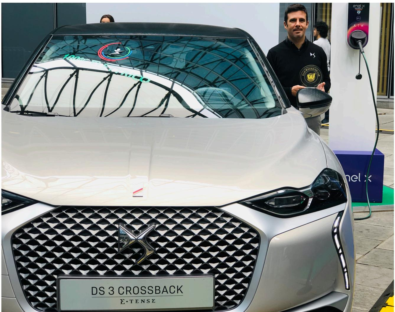
la vettura dispone di 3 modalità di guida: Eco, Normale e Sport. A queste si aggiungono due opzioni per il recupero dell'energia che provengono direttamente dalla Formula E e sono controllate dal conducente. La modalità Normale simula il comportamento di un motore termico, mentre la Brake applica una decelerazione di 1,2 m/s<sup>2</sup>. In soli 30 minuti di ricarica la vettura è in grado di ricaricarsi fino all'80 % tramite le
