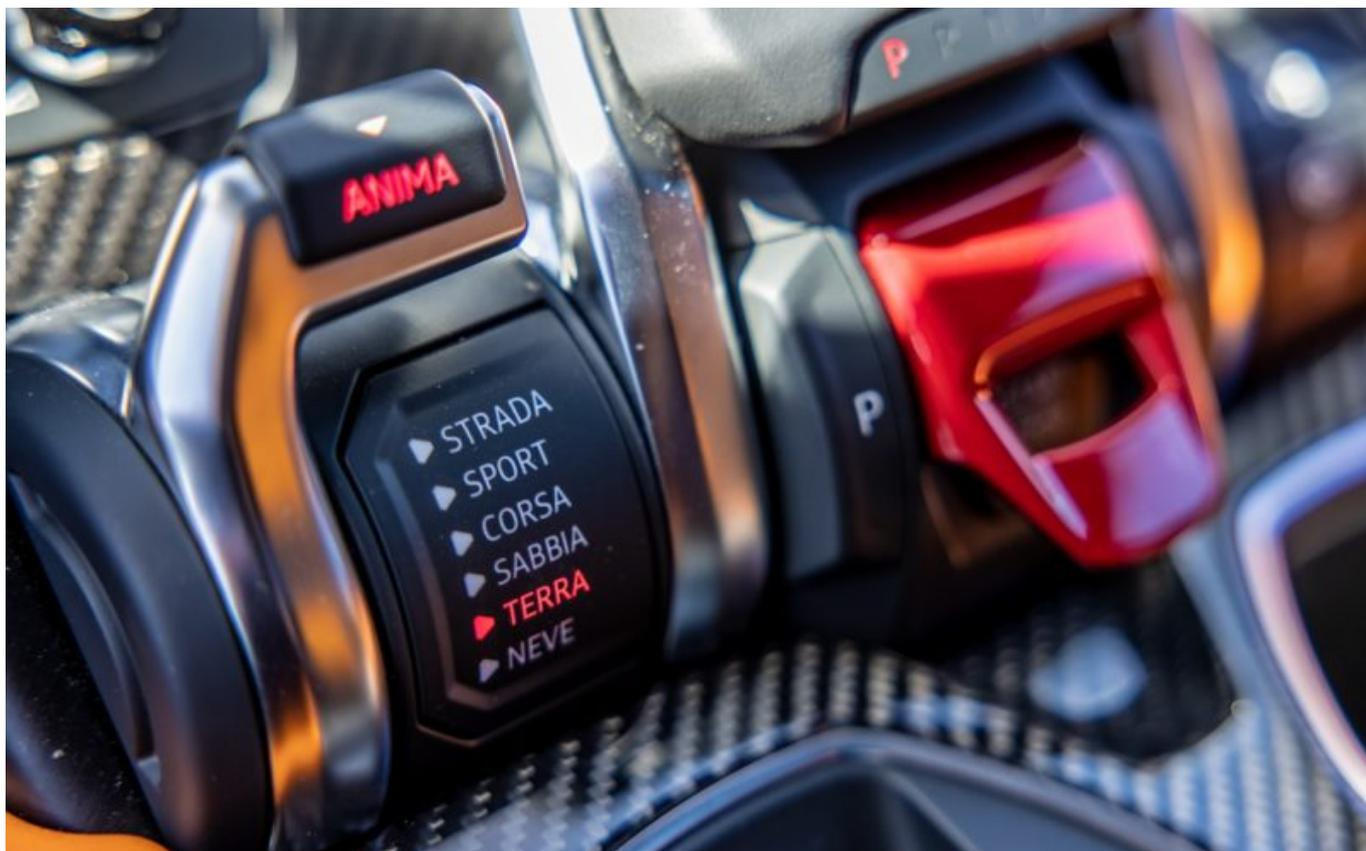
Quelle della dinamica di guida sono più complesse: il comando rotante a sinistra in basso sul tunnel centrale si chiama Anima. Dal quale si possono selezionare Strada, Sport, Corsa, Sabbia, Terra e Neve. Mentre a destra si chiama Ego: personalizza la configurazione secondo le preferenze. Ma si può anche lasciare che sia Urus a gestire il tutto: possiamo fidarci.
