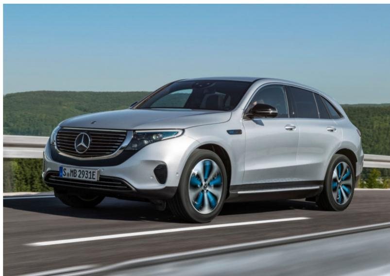
La Mercedes EQC è il primo SUV elettrico della Mercedes-Benz. Il dato fornito dalla casa, misurato secondo il vecchio ciclo NEDC, parla di 450 Km con una carica e disponendo di una stazione di ricarica rapida da 110 Kw, in 40 minuti si passa dal 10 all'80% di carica. La vettura è spinta da due motori elettrici che riescono ad erogare una potenza di ben 330 kW, pari a 408 cavalli, la coppia è invece di 765 Newton metri. Prezzi da 78.700 euro.
