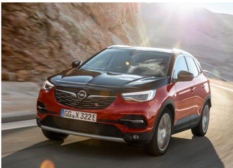
Opel Grandland X Hybrid4 un powertrain ibrido plug-in che abbina un'unità turbo benzina 1.6 litri a due motori elettrici che assicurano una potenza di sistema di 221 kW (300 CV). on questo veicolo ibrido plug-in si possono percorrere fino a 59 chilometri in modalità puramente elettrica. Prezzi da 48.900 euro.
