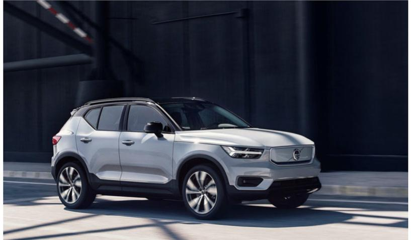
La nuova Volvo XC40 Recharge si presenta come la versione 100% elettrica del noto ed apprezzato SUV della Casa di Goteborg. La potenza complessiva è di 408 CV e 660 Nm di coppia massima, mentre i due motori elettrici sono alimentato da un pacco di batterie a litio da 78 kWh che offrono un'autonomia di oltre 400 km e possono essere ricaricate in 7 ore e mezza con rete da 11 kW e in appena 40 minuti se si sfrutta la ricarica veloce da 150 kW. Prezzi da 50.220 euro.
