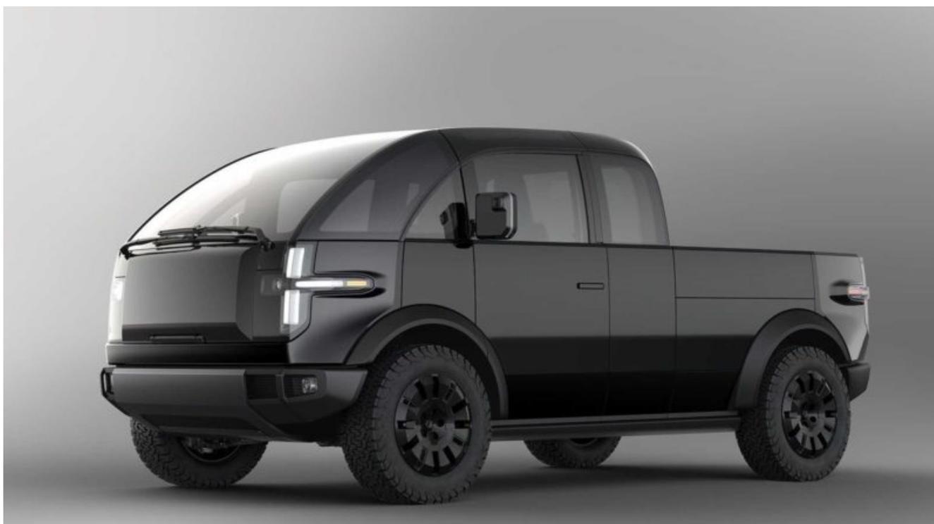
manica un pianale modulare che permette di aumentare la lunghezza del veicolo da 4,6 a 5,4 metri
