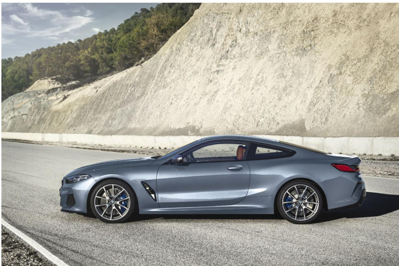
Esso, diminuendo il peso nella parte superiore della vettura, ne abbassa il baricentro, migliorando la tenuta di strada; ne guadagnano sia le prestazioni che la sicurezza. Questo materiale è usato anche per barre di aspirazione dell'aria, calotte specchietti, spoiler posteriore e diffusore aerodinamico posteriore (optional).
