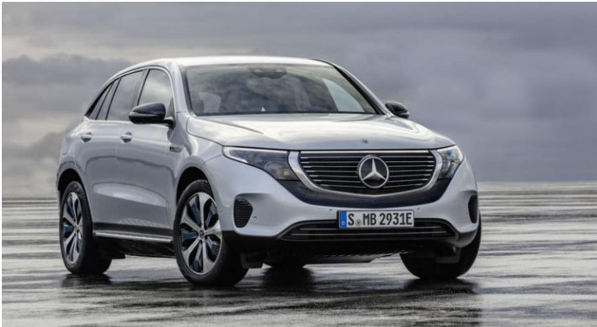
La Mercedes EQC è il primo SUV 100% elettrico della Casa della Stella alimentato da due motori asincroni che erogano una potenza massima di 300 kW e una coppia massima di 760 Nm. La vettura è in grado di offrire un'autonomia di circa 450 km (ciclo NEDC), parla di 450 Km con una carica. Se ci si rifornisce presso una stazione compatibile con una potenza massima di 110 kW, occorrono circa 40 minuti per portare il livello di carica dal 10 all'80%.
