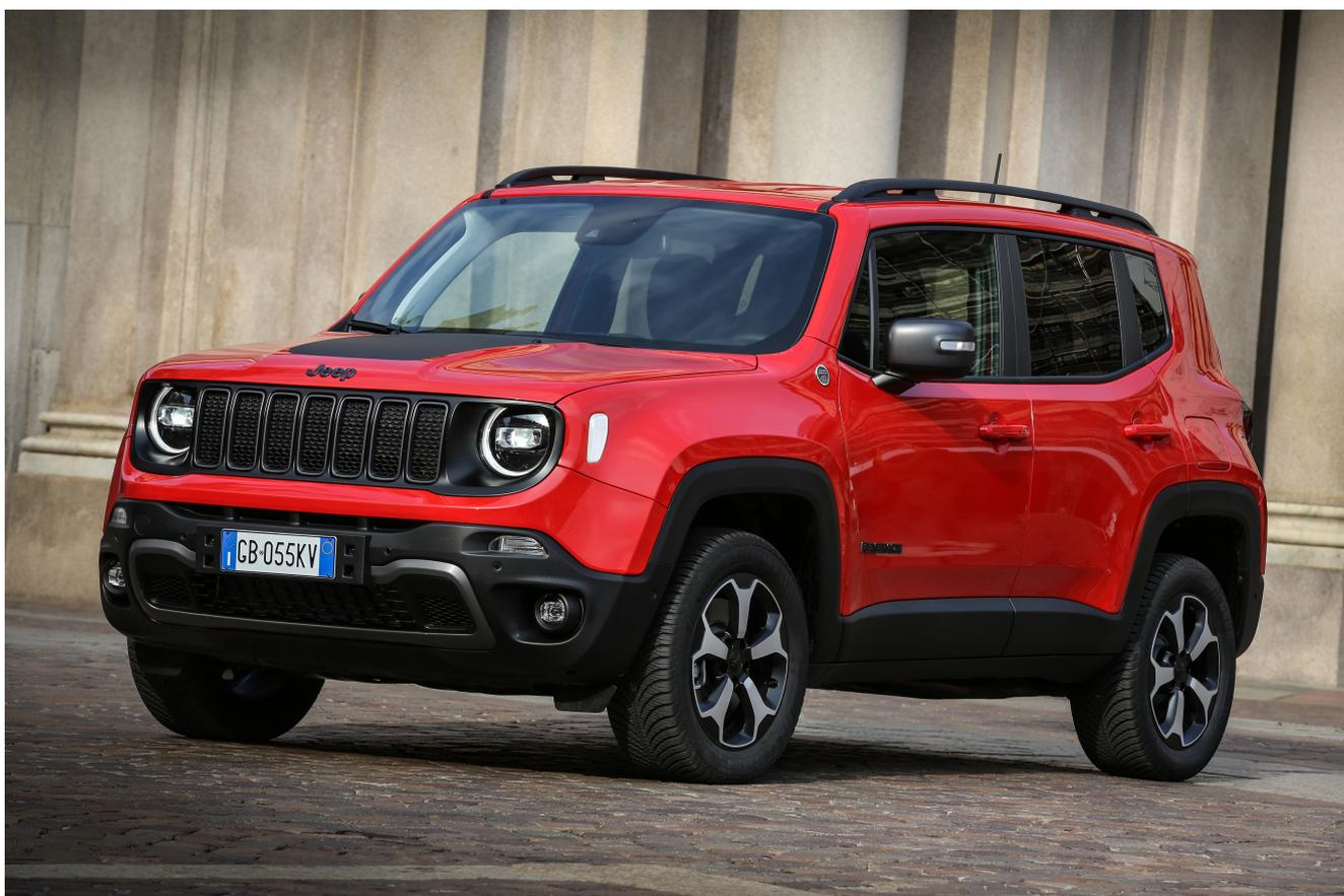
La nuova Renegade 4xe sfrutta uno schema ibrido plug-in, per una potenza complessiva di 240 CV. La batteria da 10 kWh che alimenta il moto elettrico permette di viaggiare nella modalità a zero emissioni (100% elettrica) per circa 60 km.
