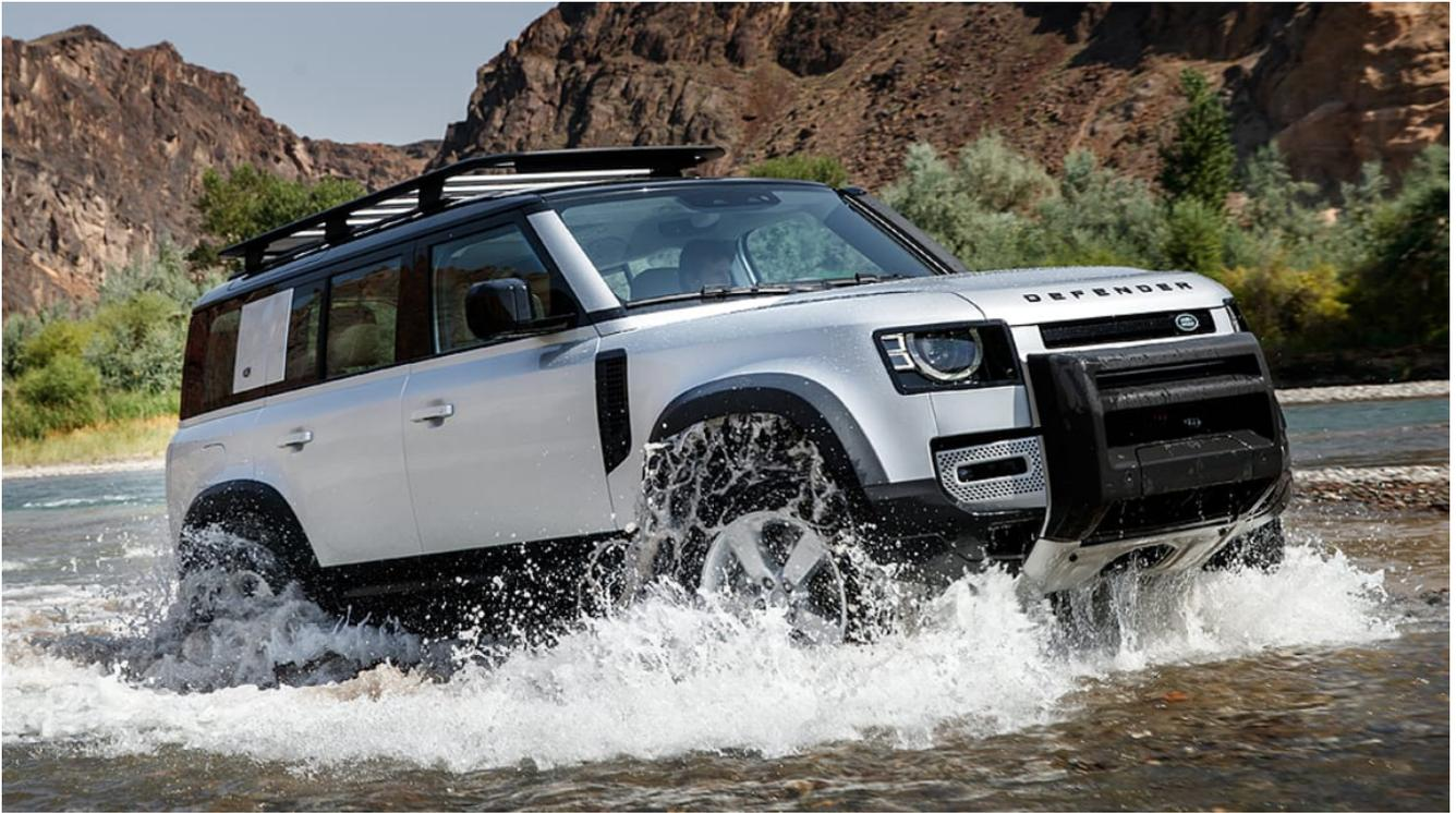
La seconda generazione dell'inarrestabile ed iconico fuoristrada Defender sposa la tecnologia plug-in hybrid che permette al veicolo di percorrere circa 50 km senza emettere un grammo di emissioni nocive. Il powertrain ibrido prende il nome di P400e e sfrutta un motore quattro cilindri benzina da 300 CV abbinato ad una unità elettrica da circa 105 kW. Anche in questa configurazione, il Defender riesce a superare guadi fino 90 cm.
