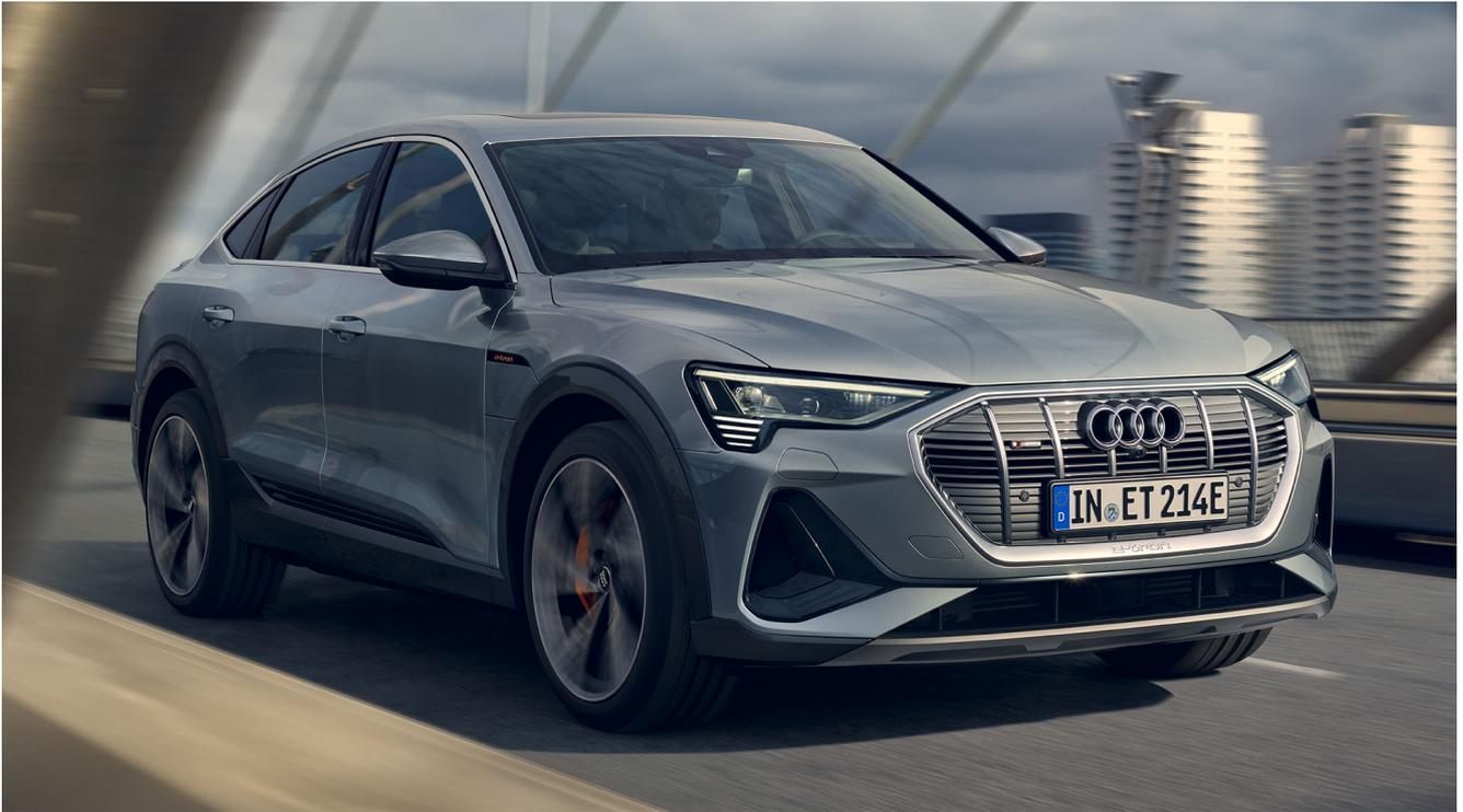
l'Audi e-tron Sportback si presenta come un SUV-coupé 100% elettrico con caratteristiche lussuose e sportive. I due motori elettrici asincroni erogano complessivamente 408 CV e 664 Nm di coppia in modalità Boost, offrendo uno scatto da 0 a 100 km/h in 5,7 secondi.
