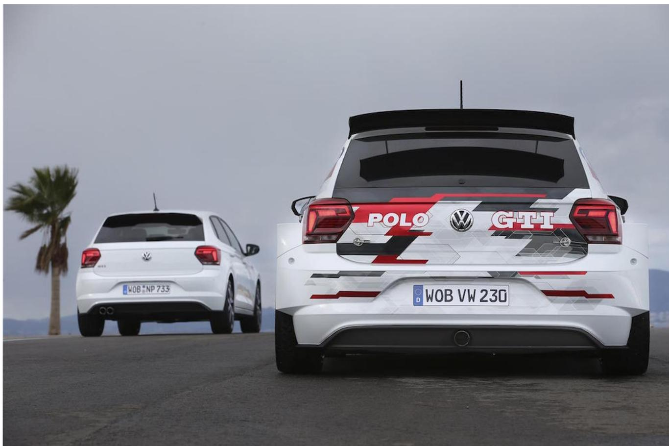
Per gli appassionati dei rally Volkswagen ha sviluppato una nuova vettura: quattro cilindri turbo ad iniezione diretta, 272 CV e 400 Nm (mostruosi), **trazione integrale** e naturalmente **trasmissione sequenziale** (a cinque rapporti). Il peso è di **1.320 kg**, con uno zero-cento di **4,1 secondi**.
