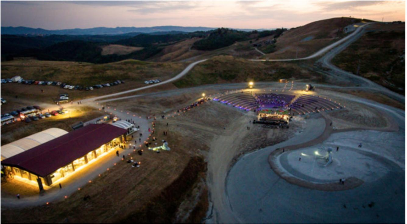
La vocazione “verde” della discarica, nata nel 1997, non si ferma. Negli ultimi anni, è stata dotata di un impianto di **trattamento meccanico biologico** per **estrarre materiali riciclabili dai rifiuti indifferenziati** e di un impianto di cogenerazione per la **produzione di energia derivante dal biogas**. Nel futuro prossimo, poi, sorgerà anche un impianto di **compostaggio** per la produzione di **biometano**, derivante dai rifiuti “umidi”.
